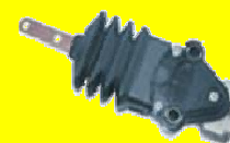
LCV-6124 VALV. NIVELADORA P/CABINA T/PALETA
